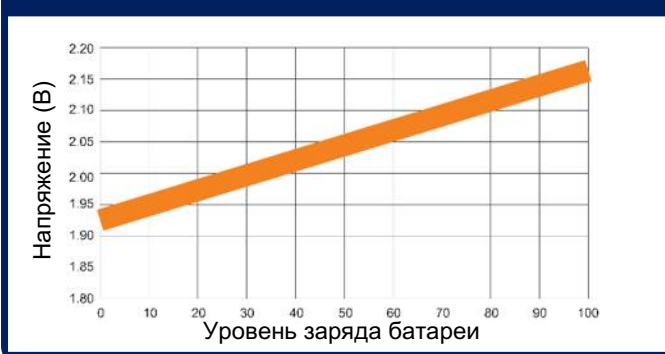
Зависимость напряжения от уровня заряда (20°C)
